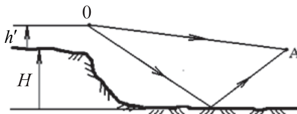
Рис. 3.13. Распространение радиоволн в случае расположения излучателя у края обрыва
