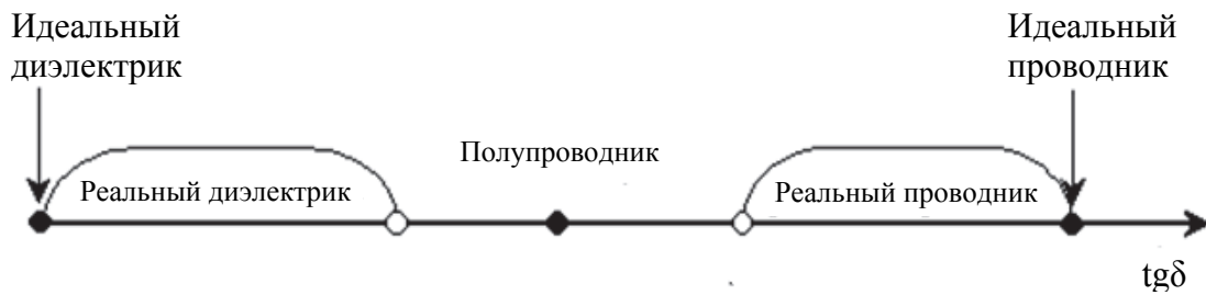
Рис. 2.20. Классификация сред в зависимости от тангенса угла потерь
