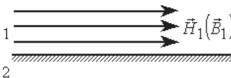
Рис. 2.19. Силовые линии магнитного поля на границе с идеальным проводником
