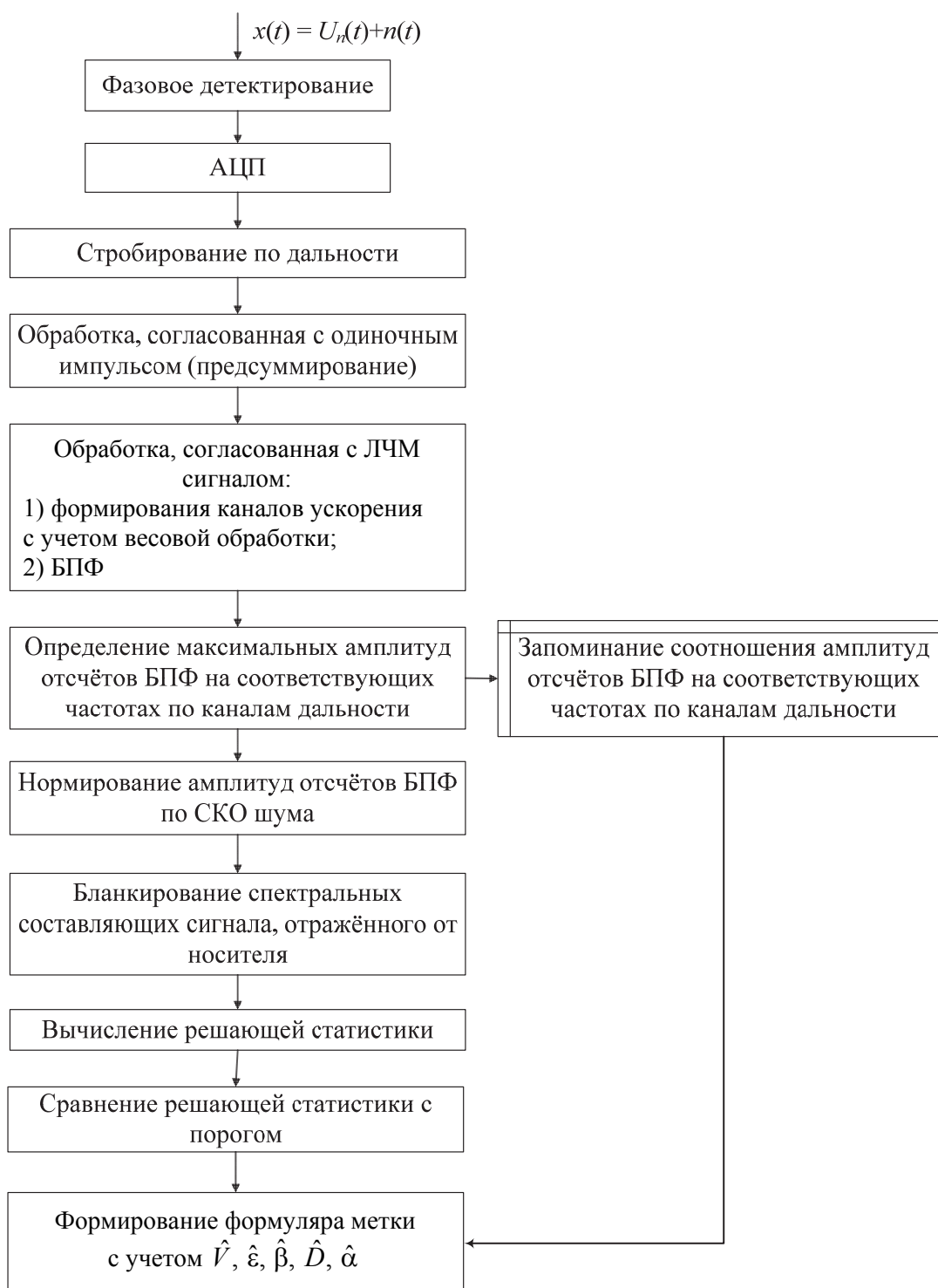
Рис. 2.16. Структура метода обнаружения пущенной противником УР класса «воздух – воздух» на этапе сопровождения её носителя
