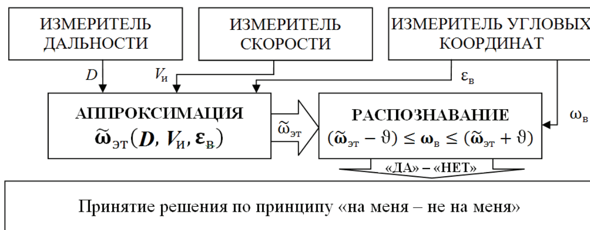
Рис. 6.9. Структура метода распознавания направления полёта управляемой ракеты противника
