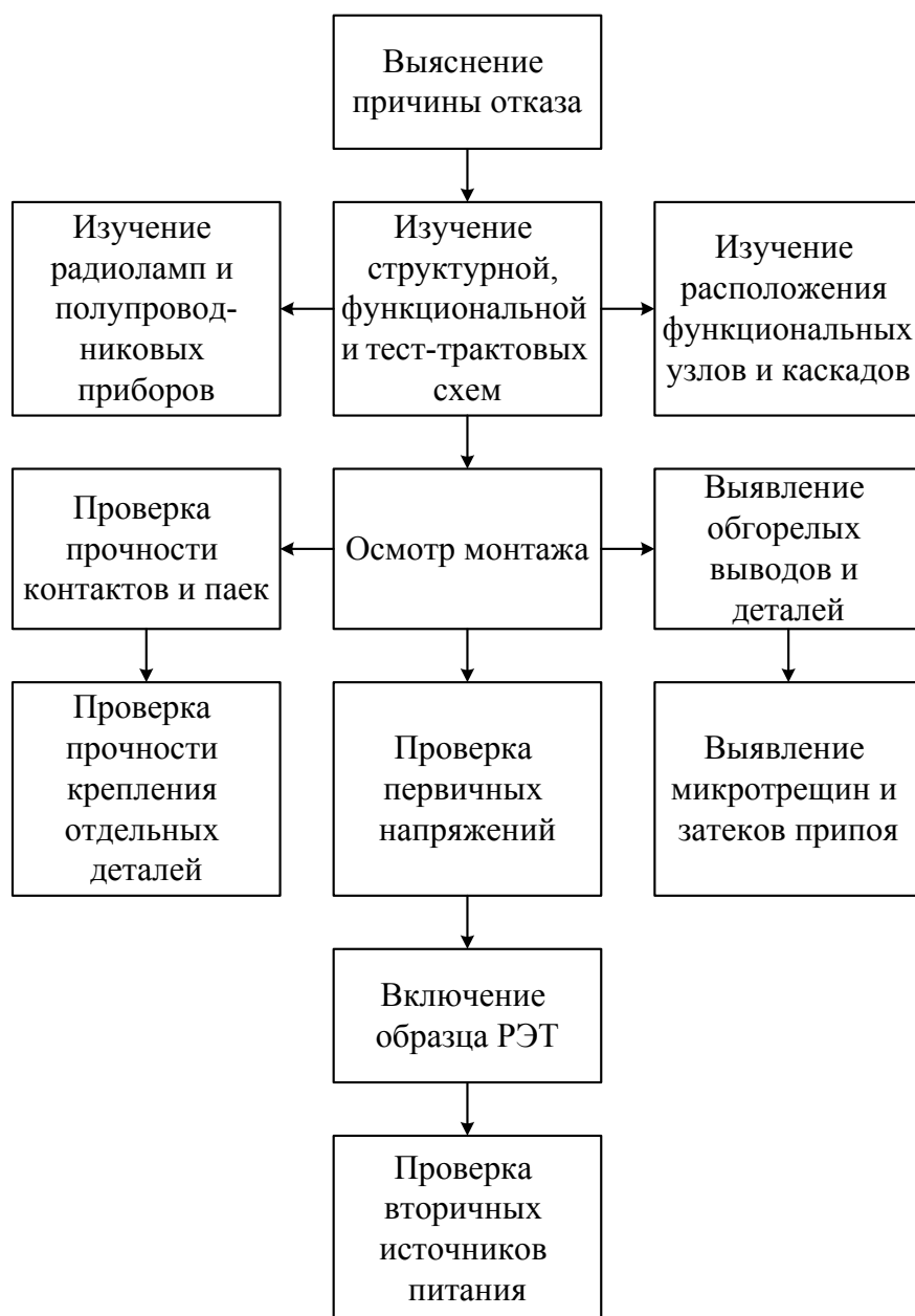
Рис. 2.1. Технологическая схема проверки ремонтируемого изделия
