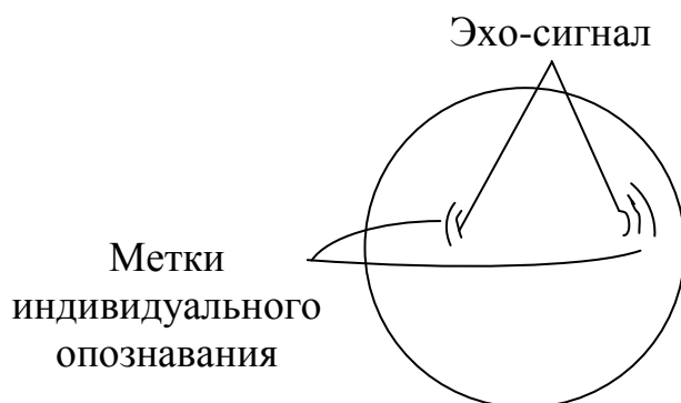
Рис. 1.15 Вид экрана индикатора с метками эхо-сигналов и индивидуального опознавания
