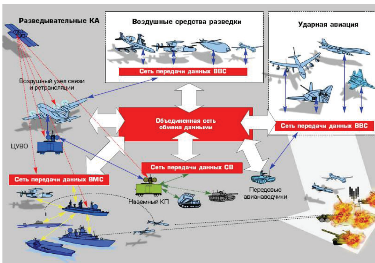
Рис. 2.32. Сетевое взаимодействие в рамках концепции «Ведение боевых действий в едином информационном пространстве»
