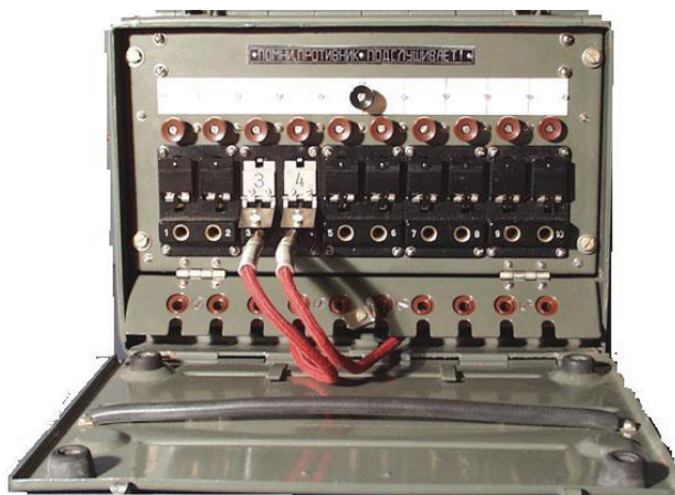
Рис. 6.8. Полевой телефонный коммутатор П-193
