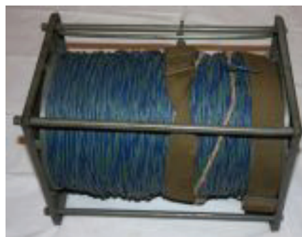
Рис. 6.10. Катушка ТК-2 с полевым телефонным кабелем П-274
