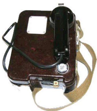
Рис. 6.9. Полевой телефонный аппарат ТА-57
